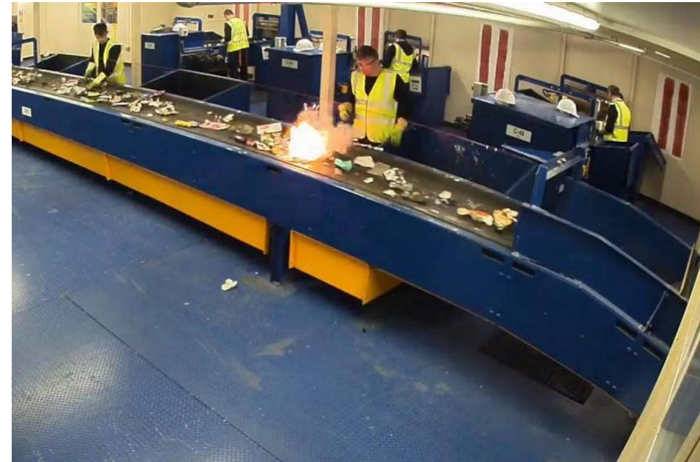
Bei fehlerhafte Entladung können Li-Ion Batterien in Shredderanlagen explodieren
